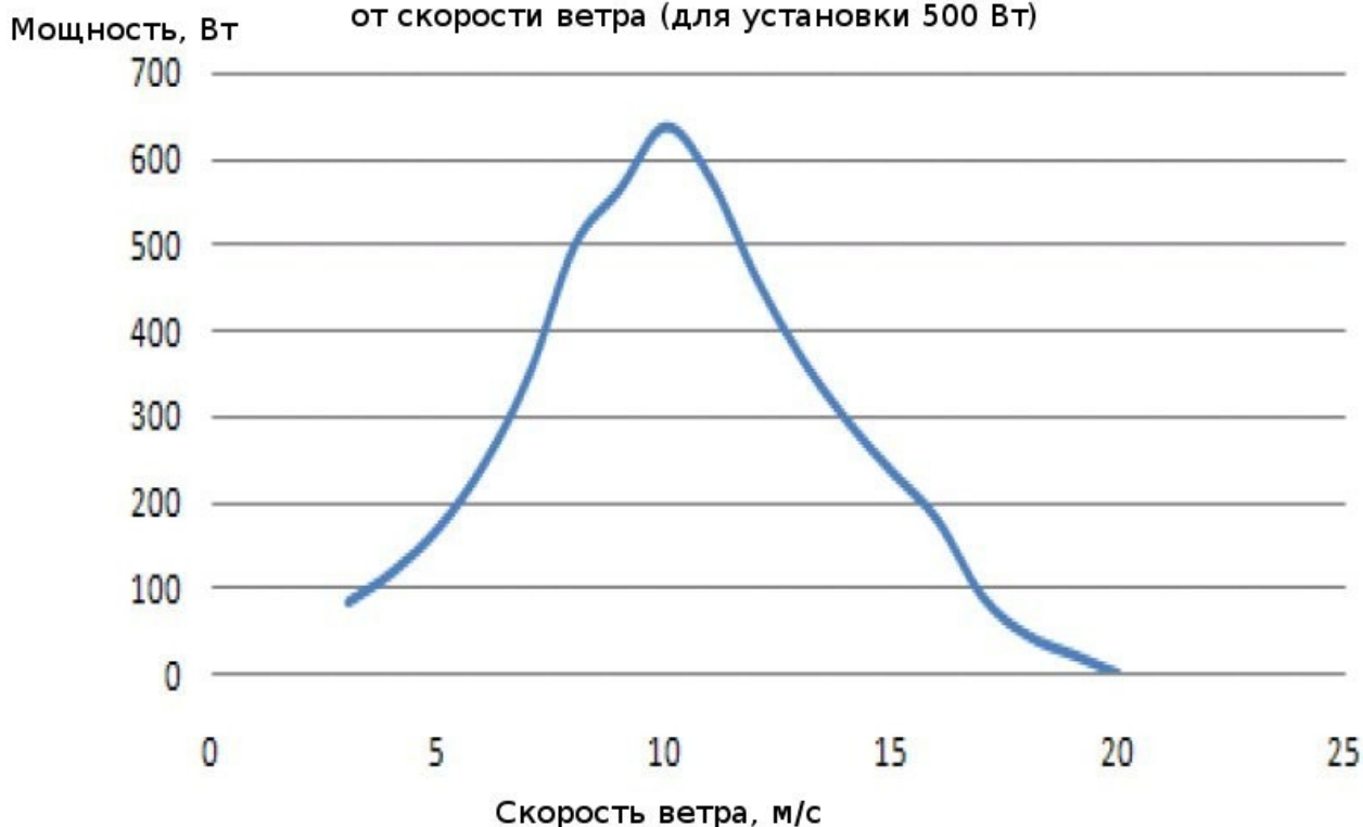
График 1. Зависимость вырабатываемой мощности от скорости ветра (для установки 500 Вт)
