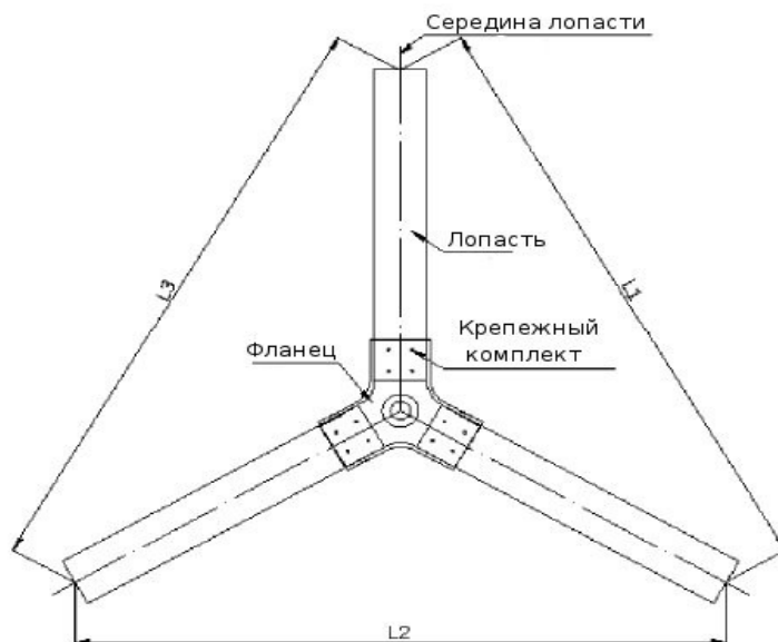
Рис. 3.10 Схема соединения лопастей
