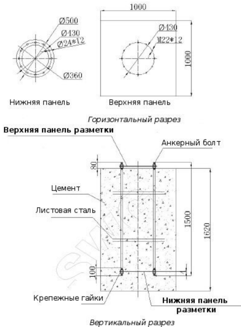
Рис. 4.1 Схема бетонирования опоры для свободно стоящей мачты
